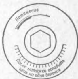
Рис. 9. Указатель натяжения распределительной цепи
